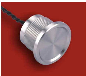
PS223Z□Y◆1 Panel size 安装孔尺寸: \Phi 22\text{mm} IP degree 防护等级: IP69K, IK10
